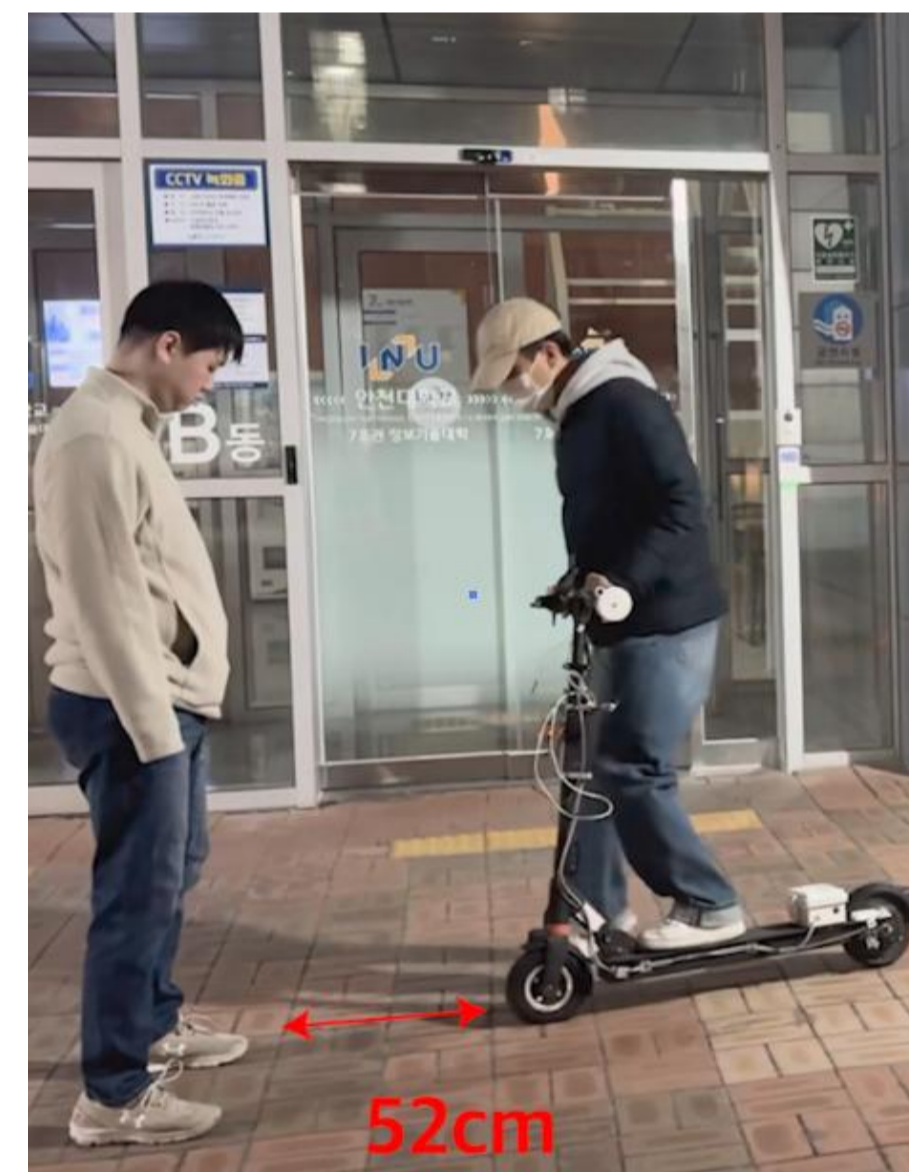
위험 판단 시, 브레이크 자동 작동 킥보드가 스스로 속도를 줄이며 감속
